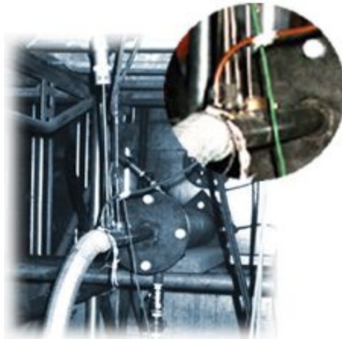
Abb. 10: Wassergekühlte Lanze zur Rauchgasabsaugung
